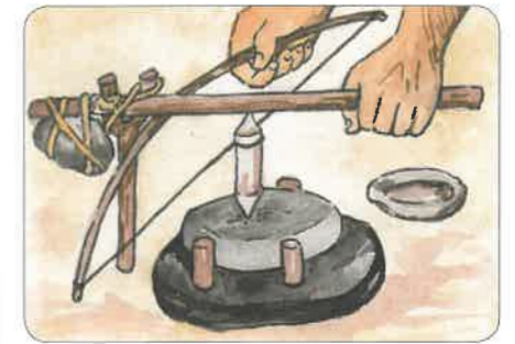
vrtání otvoru do kamene
